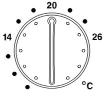
Der Raumtemperatur-Nennsollwert wird durch Drehen am Temperaturreglerknopf vorgewählt. Dieser ist für den Benutzer direkt auf der Reglerfront zugänglich.
