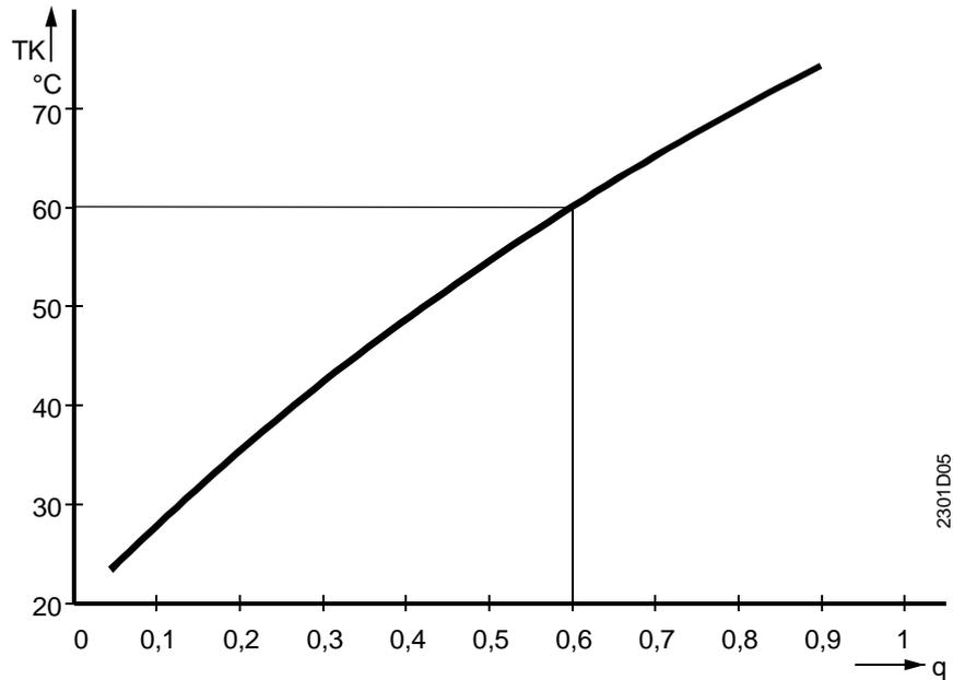
Bildung des Kesseltemperatur-Sollwertes bei "reiner" Lastführung
