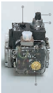
① Startgasmenge ③ Gasmenge ② Gasdruck ④ Gasdruckwächter
