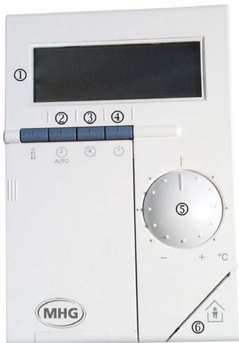
Abb. 1: Legende: ① Anzeige ② Taste Automatikbetrieb ③ Taste Handbetrieb ④ Taste Frostschutz ⑤ Korrekturknopf für normale Raumsollwerttemperatur ⑥ Anwesenheitstaste
