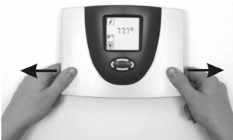
Abb. 11: Die beiden Fixierlaschen am Gehäuseoberteil kräftig nach außen ziehen und das Gehäuseoberteil soweit hochklappen, bis dieses einrastet. Der Regler kann nun bequem montiert und verdrahtet werden.
