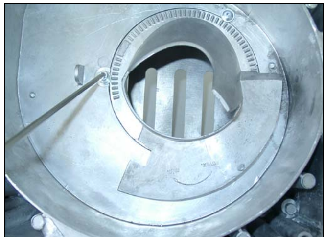
Abb. 7: Einstellung der Lufteinlaufdüse
