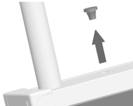
Abb. 82: Stopfen vorsichtig aus dem Kollektorgehäuse entfernen.
