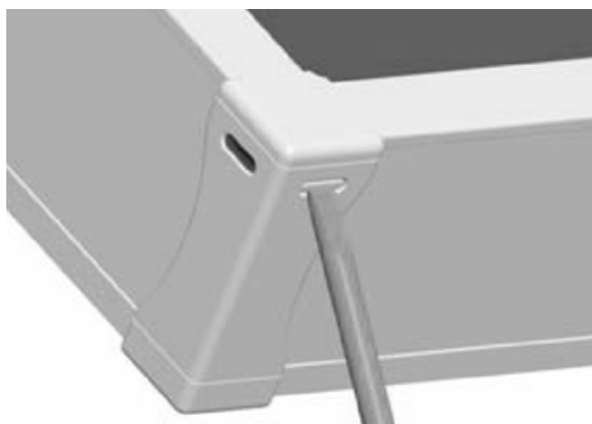
Abb. 73: Entsprechend der Aufstellung an beiden unteren Kollektorecken jeweils beide Entwässerungslöcher mit Hilfe eines Schlitzschraubenziehers ausbrechen. Dabei an der Unterkante ansetzen.
