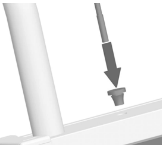
Abb. 83: Stopfen über den Temperaturfühler (im Lieferumfang des Solarreglers enthalten) schieben.
