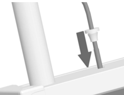
Abb. 84: Temperaturfühler bis zum Anschlag in die Tauchhölse einföhren. Kollektorgehäuse mittels Stopfen abdichten. Dabei auf korrekten Sitz der Stopfen achten.
