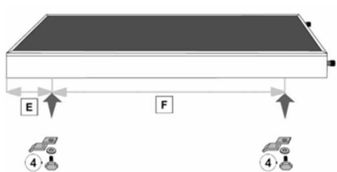
Abb. 42: Montage der Quickies ④ Beachten Sie die Maße E und F . Das Maß E sollte nicht größer als 50 cm sein, das Maß F sollte 5 cm größer als der Abstand der Profilschienen sein. Dies erleichtert die spätere Montage auf dem Dach.
