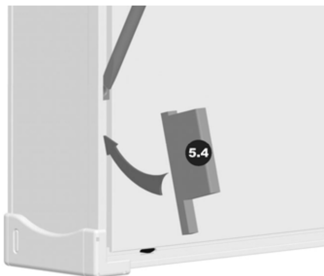
Abb. 69: Vierkantmuttern in der Nut auf der Kollektorrückseite mit einem Schraubenzieher ausrichten und mittels der Montagehilfe (5.4) fixieren.
