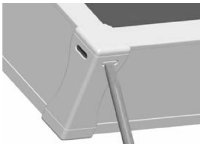
Abb. 43: Entsprechend der Montage auf dem Dach an beiden unteren Kollektorecken jeweils beide Entwässerungslöcher mit Hilfe eines Schlitzschraubenziehers ausbrechen. Dabei an der Unterkante ansetzen.
