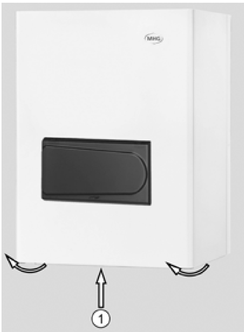
Abb. 22: Zum Abnehmen der Verkleidung der Inneneinheit die Schraube ① an der Unterseite entfernen, dann die Haube in Pfeilrichtung abheben. Hierbei die Fixierungspunkte oben rechts und links beachten.
