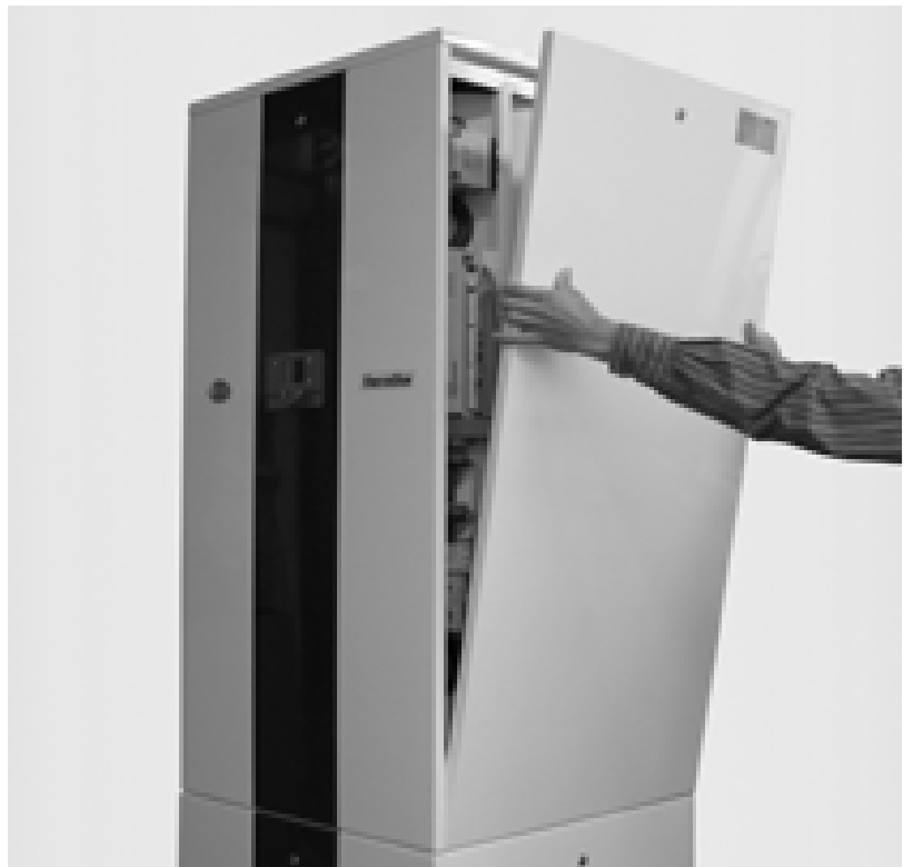
Abb. 34: Seitenverkleidung ankippen und nach oben aus den Zapfen herausheben.
