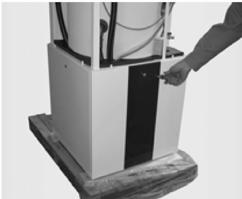
Abb. 13: Schnellverschluss-Schraube der vorderen unteren Verkleidung zur Demontage lösen (90°)
