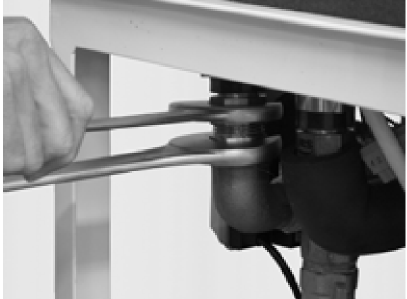
Abb. 18: Überwurfmutter der Schläuche lösen und abschrauben.
