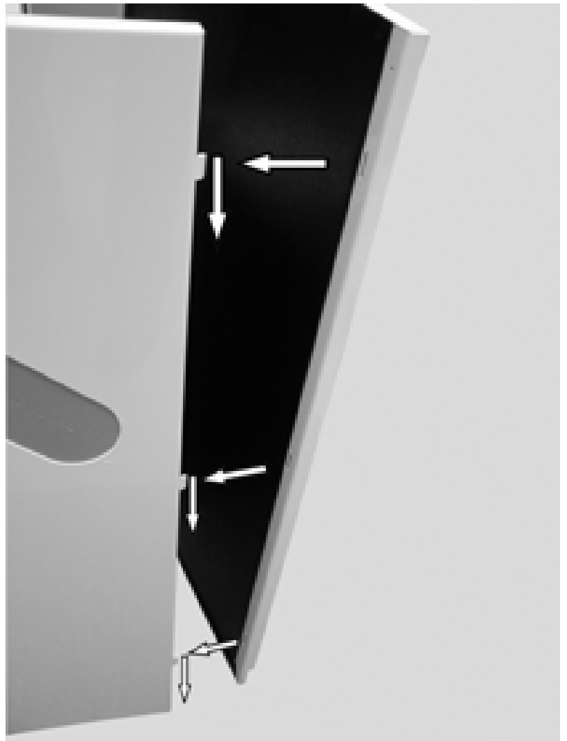
Abb. 22: Seitenverkleidungen in die Rasthaken der hinteren Verkleidung einhängen.
