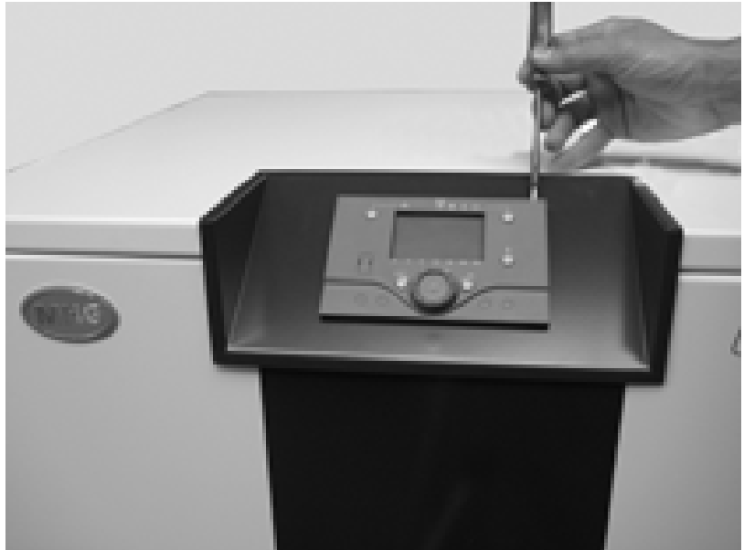
Abb. 36: Schraubendreher gem. Abb. in die rechte, dann in die linke obere Aussparung stecken, die Verrastung herunter und dabei den Schraubendreher nach vorne drücken.
