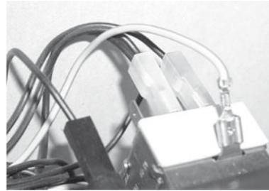
Die braune Leitung wird auf den freigewordenen Anschluss des STB gesteckt. Der Schutzleiter (grün-gelb) wird „Huckepack“ an die bestehende Steckverbindung am STB angeschlossen.
