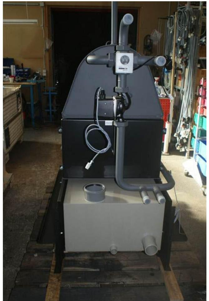
➤ Wenn Kesselkörper zum Transport getrennt wurde: Oberen Teil auf Abstand aufsetzen, Hochtemperatursilikon aufbringen Ober- und Unterteil verschrauben, Verschraubung anziehen Verrohrung Kesselpumpe anziehen
