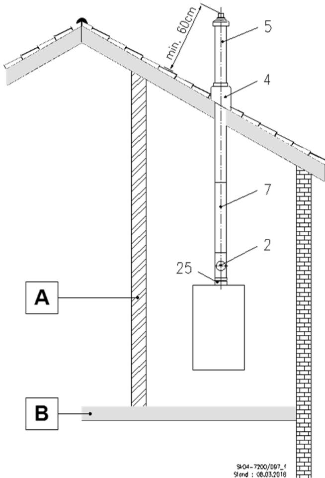
Abb. 31: C<sub>33x</sub> Dachheizzentrale mit der Durchführung senkrecht durch ein Schrägdach
