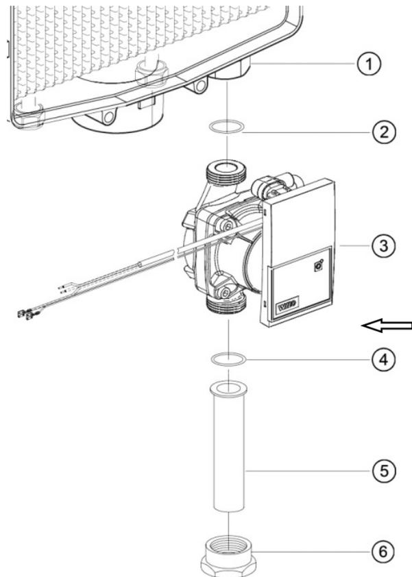
Abb. 74: Verschraubungen der Umwälzpumpe
