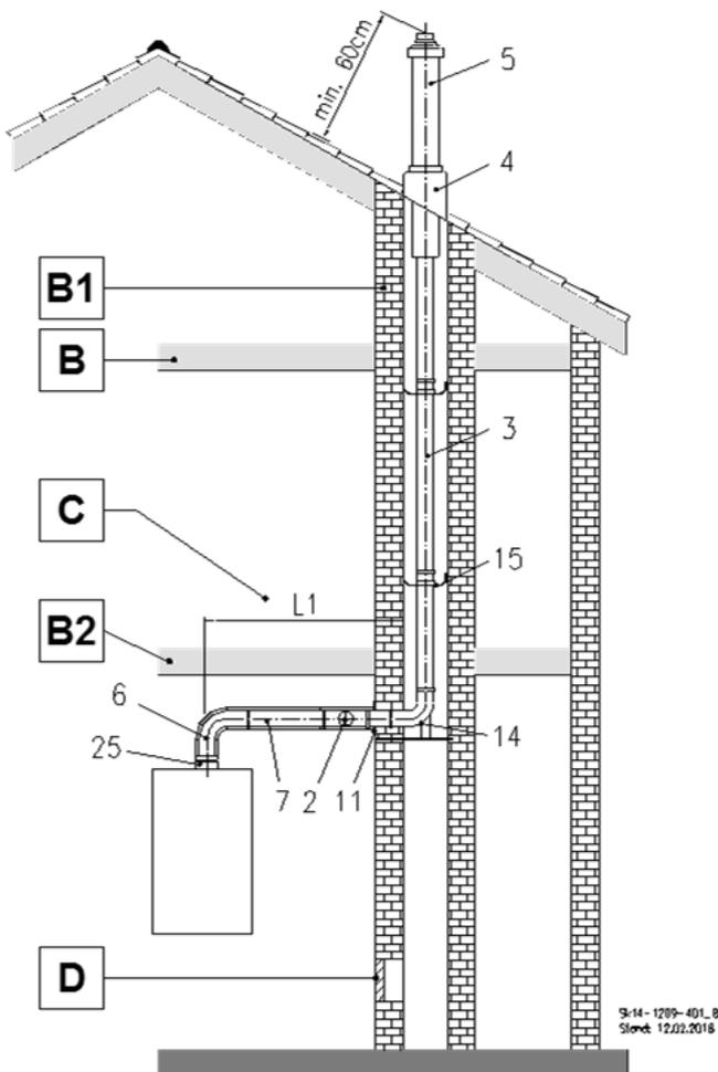
Abb. 36: C<sub>93x</sub> Luft-Abgas-System im Schacht und Luft-Abgas-Rohrsystem mit Dachdurchführung
