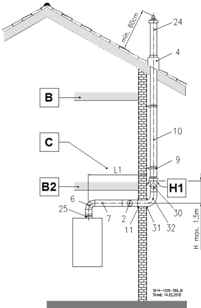
Abb. 33: C<sub>53x</sub> Außenwandführung LAS
