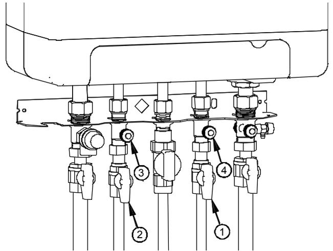
Abb. 80: Spülanschlüsse der Trinkwarmwasserschlange beim Kombi
