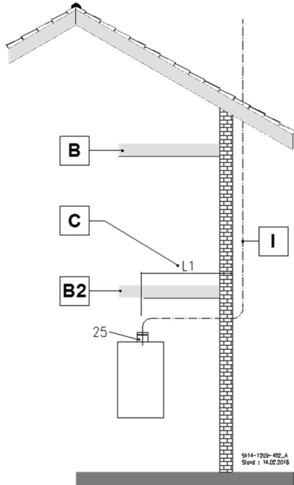
Abb. 34: C<sub>63x</sub> Für Anschluss an eine nicht mit der Gasfeuerstätte geprüfte Verbrennungsluftzuführung und Abgasabführung
