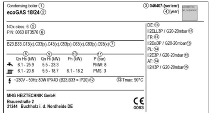
Abb. 92: Muster Typenschild ecoGAS Kombi
