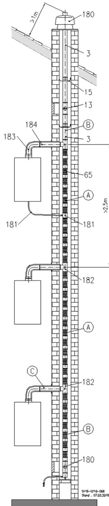
Abb. 39: C<sub>43x</sub> Mehrfachbelegung im Schacht (Legende s. nächste Seite)
