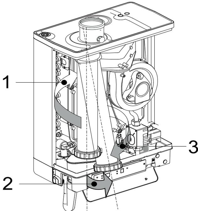
Abb. 70: Demontage Abgasrohr
