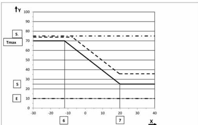
Abb. 64: Heizkennlinie mit Parallelverschiebung (T<sub>RaumSoll</sub> = 24°C, r = 3) und Begrenzung durch Parameter „5.“
