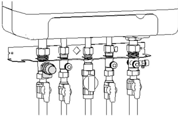
Abb. 15: Montage Sicherheitsventil
