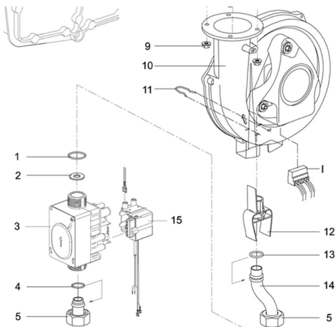
Abb. 67: Komponenten des Gas-Luft-Verbundes
