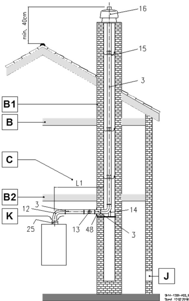
Abb. 27: B<sub>23</sub> Abgasrohr im Schornstein
