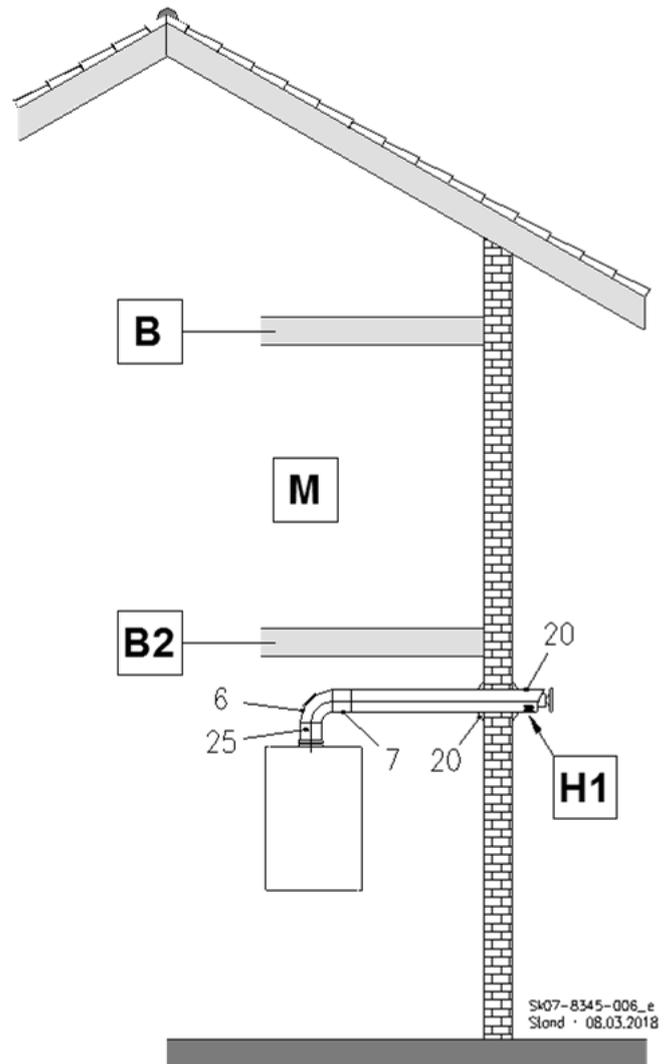
Abb. 29: C<sub>13x</sub> Luft-Abgas-Rohrsystem horizontal durch die Außenwand
