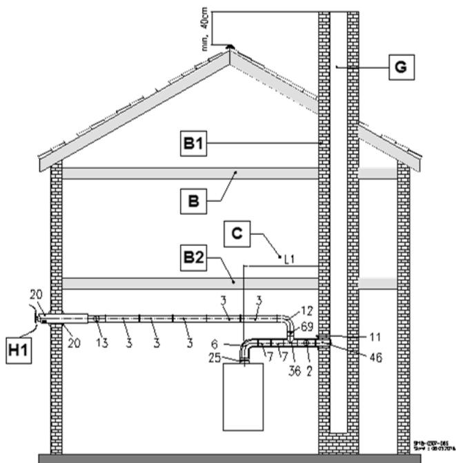
Abb. 35: C<sub>83x</sub> Anschluss an einen feuchte-unempfindlichen Abgasschornstein und Zuluft durch die Außenwand
