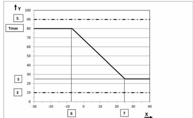
Abb. 61: Heizkennlinie gemäß Werkseinstellungen
