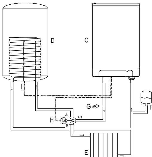
Abb. 21: Trinkwarmwasserbereitung mit externem Speicher über 3-Wege-Umschaltventil
