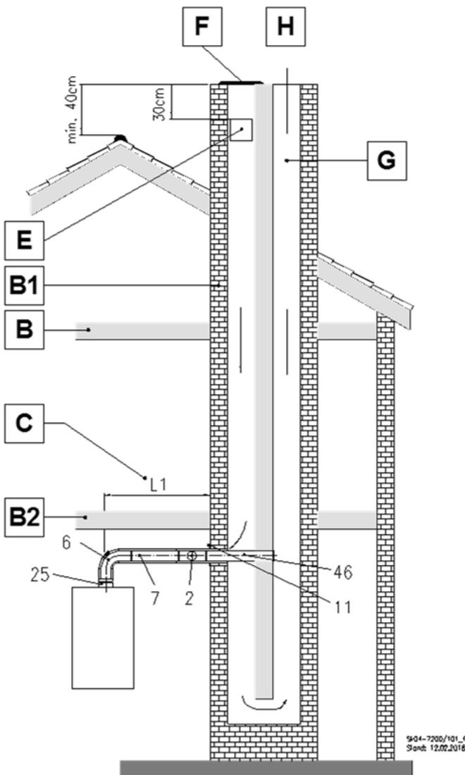
Abb. 32: C<sub>43x</sub> Anschluss an ein Luft-Abgas-System (LAS)
