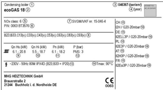
Abb. 91: Muster Typenschild ecoGAS Heizer
