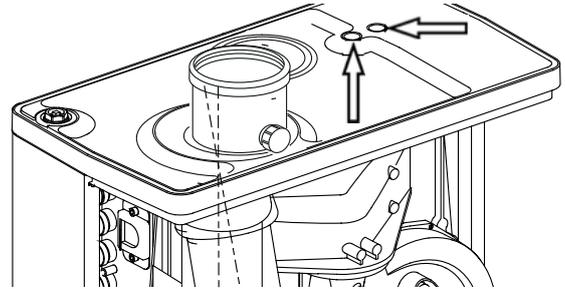
Abb. 72: Stopfen/Öffnungen des Gehäuses
