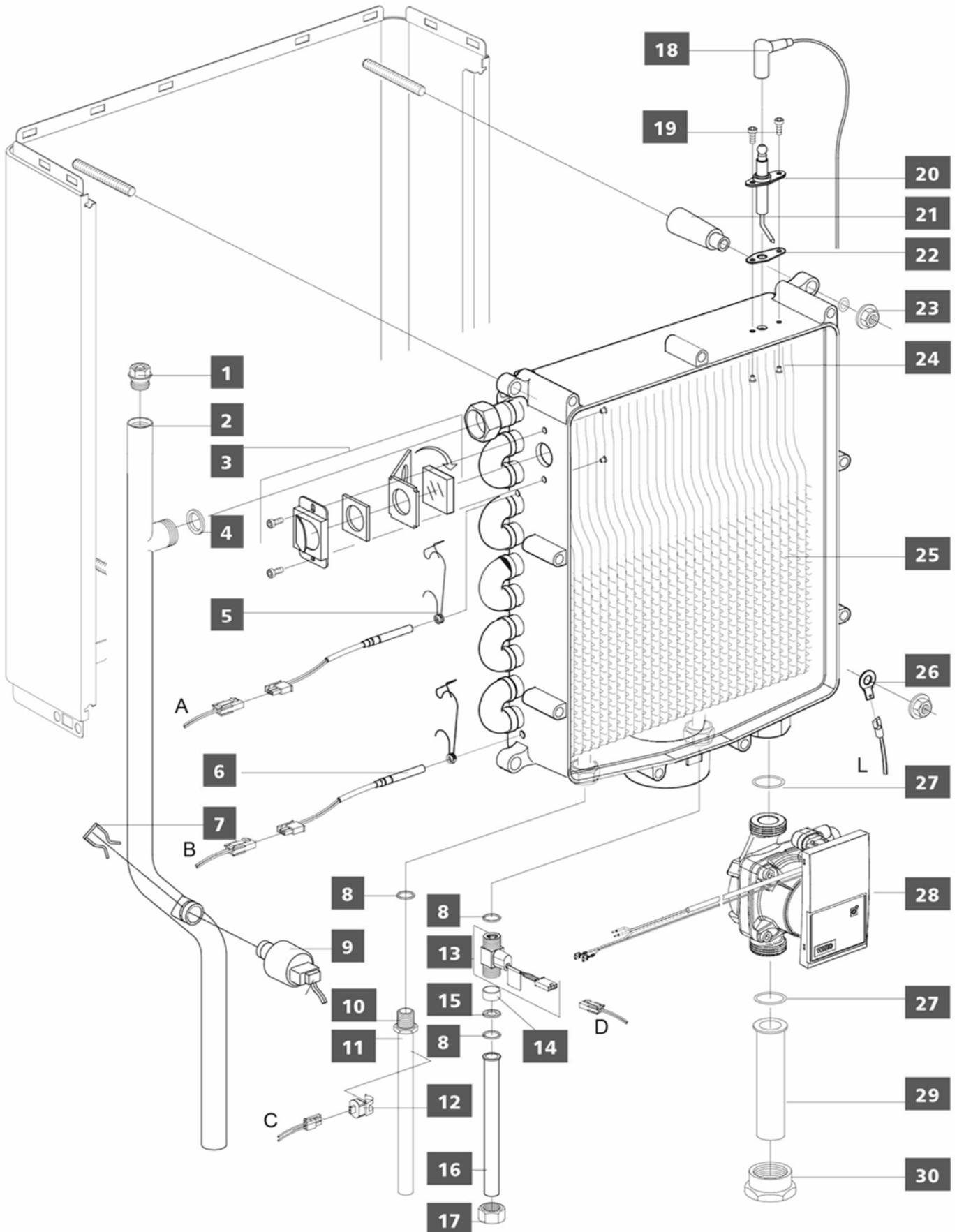
Abb. 83: Wärmetauscher, wasserseitig ecoGAS.../ ecoGAS Kompakt
