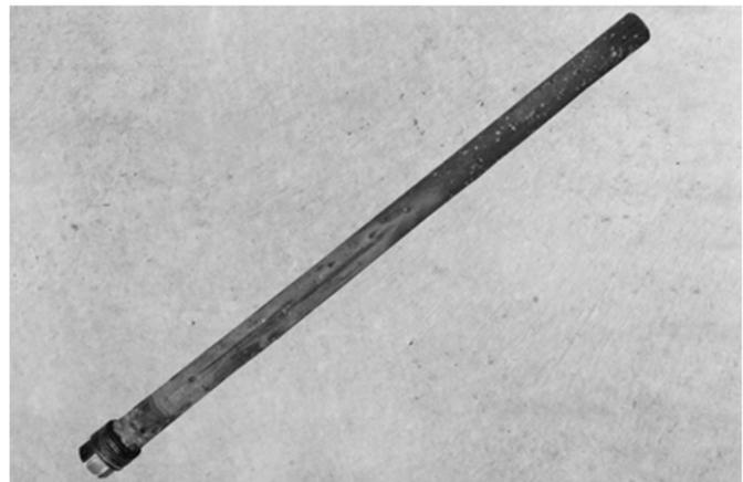
Abb. 78: Magnesium-Schutzanode, Länge 480 mm, Ø 26 mm
