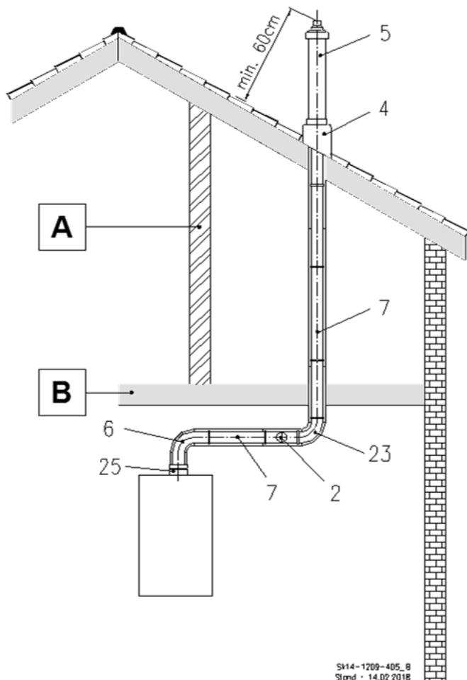
Abb. 30: C<sub>33x</sub> Luft-Abgas-Rohrsystem senkrecht durch eine Decke und eine Dachhaut
