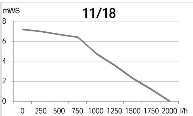
Abb. 93: Restförderhöhe ecoGAS 11, 18, 18/24 und Kompakt
