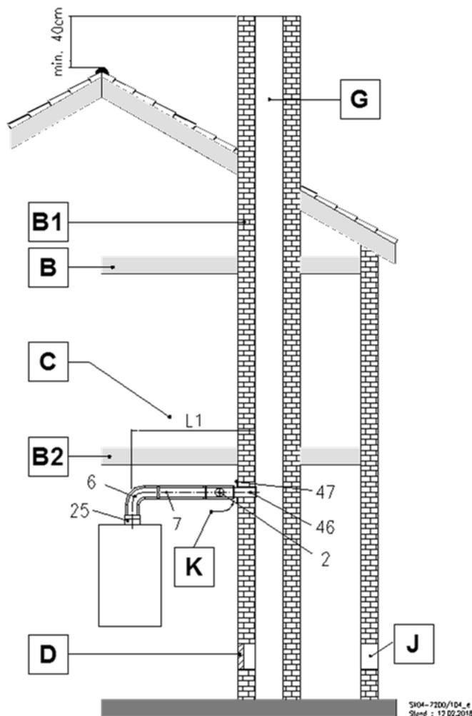
Abb. 28: B<sub>33</sub> Abgasrohr endet im feuchteunempfindlichen Schornstein
