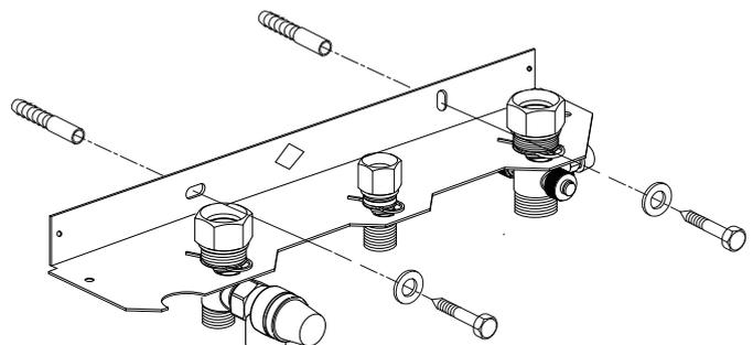
Abb. 10: Anschluss-Schiene ecoGAS Heizer
