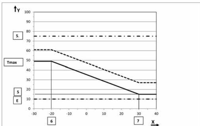
Abb. 63: Heizkennlinie mit Parallelverschiebung (T<sub>RaumSoll</sub> = 24°C, r = 3)
