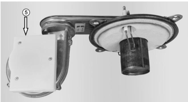
Abb. 32: Demontage Gas-Luft-Mischkasten
