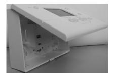
Schritt 2 Buskabel mit den Schraubklemmen verbinden.
