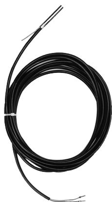
Der Temperaturfühler KVT 20 ist als Tauchfühler mit angesossenem Kabel ausgebildet und dient zur Erfassung der Kessel- und Warmwassertemperatur. Beim Kessel erfolgt die Einbringung in die Tauchhülse zusammen mit den Fühler-elementen des Sicherheitstempereaturbegrenzers (STB), des Kesseltemperaturreglers (KTR) und der Kesseltemperaturanzeige (KTA). Die im Fühler eingearbeitete Spannfeder sorgt für den erforderlichen Anpressdruck.
