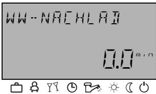
Durch längeres Drücken (ca. 3 s) der Taste gelangen Sie zur Nachladefunktion, in der die Nachladezeit in min eingestellt wird. Bei einer Nachladezeit von 0 min wird die Ladung einmalig gestartet und der WW-Tank auf Tages-Sollwert aufgeladen. Die Zeit für diese überlagerte WW-Ladung kann zwischen 0 und 240 min eingestellt werden. Hierbei wird das aktuelle Wochenprogramm überlagert.
