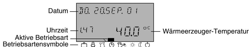
Die Beleuchtung des Displays wird bei Betätigen einer beliebigen Taste bzw. des Eingabeknopfes eingeschaltet und schaltet sich automatisch aus, wenn längere Zeit (2 Min.) keine Taste betätigt wird.
