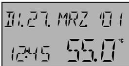
Sofern keine Fehlermeldung vorliegt, erscheint im Anschluss daran die Grundanzeige mit Datum, Uhrzeit und aktueller Temperatur des Wärmereizers
