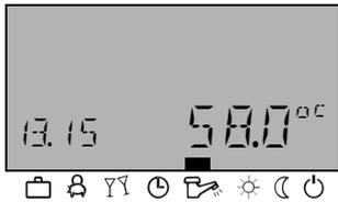
Bei manuellem Sommerbetrieb bleibt nur der Wassererwärmerkreis in Funktion und regelt die Wassererwärmertemperatur nach der vorgegebenem Warmwassertemperatur und vorgegebenem Wassererwärmer-Schaltzeitenprogramm. Der Heizbetrieb wird frostgesichert unterbunden.
