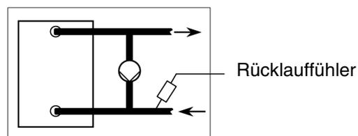
Bypassschaltung mittels Rücklauf-Bypasspumpe
