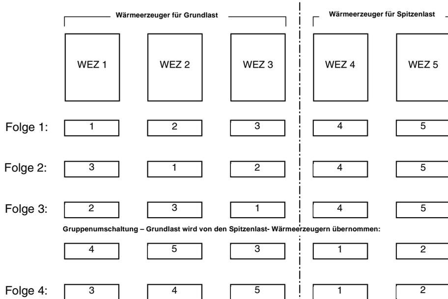
Gegebenenfalls ist es sinnvoll, Spitzenlastkessel die Grundlast übernehmen zu lassen, sofern diese angefordert werden. Dies ist über entsprechende Parametrierung möglich.
