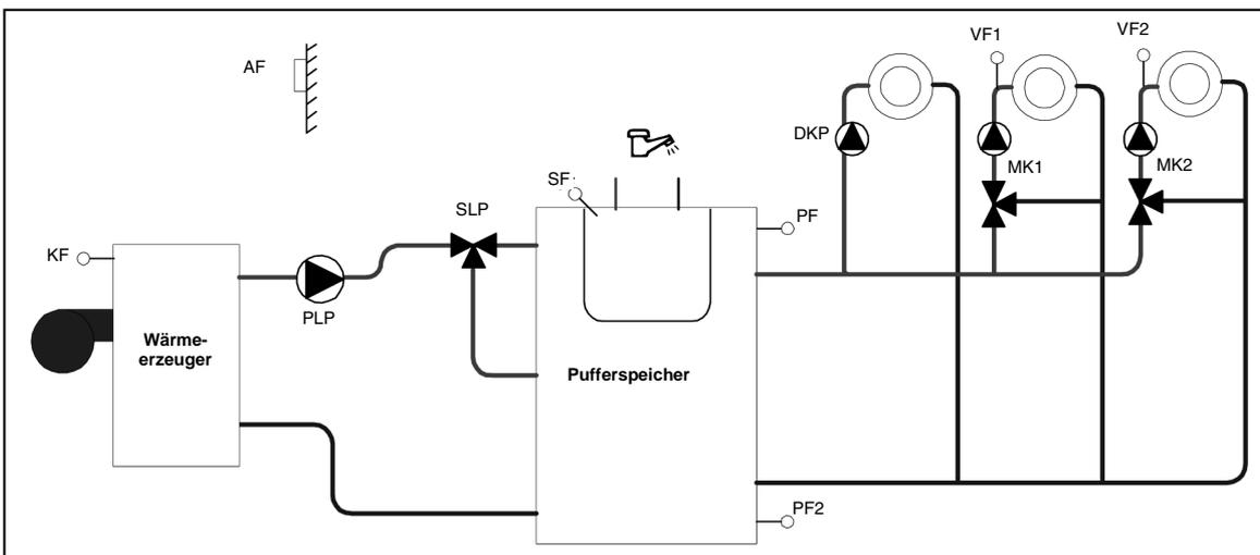
Die Heizkreisregelungen geben ihren Anforderungswert an die Pufferregelung. Die Warmwasser- und die Pufferregelung fordern bei Bedarf Energie vom Wärmeerzeuger an. Der Ausgang PLP ist während einer Pufferladung und während einer Warmwasserladung EIN.
