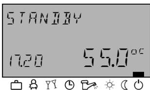
Im *STANDBY*-Betrieb wird die gesamte Anlage frostgesichert ausgeschaltet (alle Frostschutzfunktionen aktiv).
