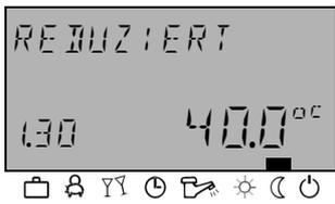
Die Betriebsart *REDUZIERT* bewirkt einen ständig reduzierten Heizbetrieb nach der vorgegebenen abgesenkten Raumtemperatur entsprechend der in den Heizkreisebenen eingestellten reduzierten Betriebsart ECO (frostgesicherter Abschaltbetrieb) bzw. ABS (Absenkbetrieb) unter Berücksichtigung der Minimaltemperaturbegrenzung des jeweiligen Heizkreises.
