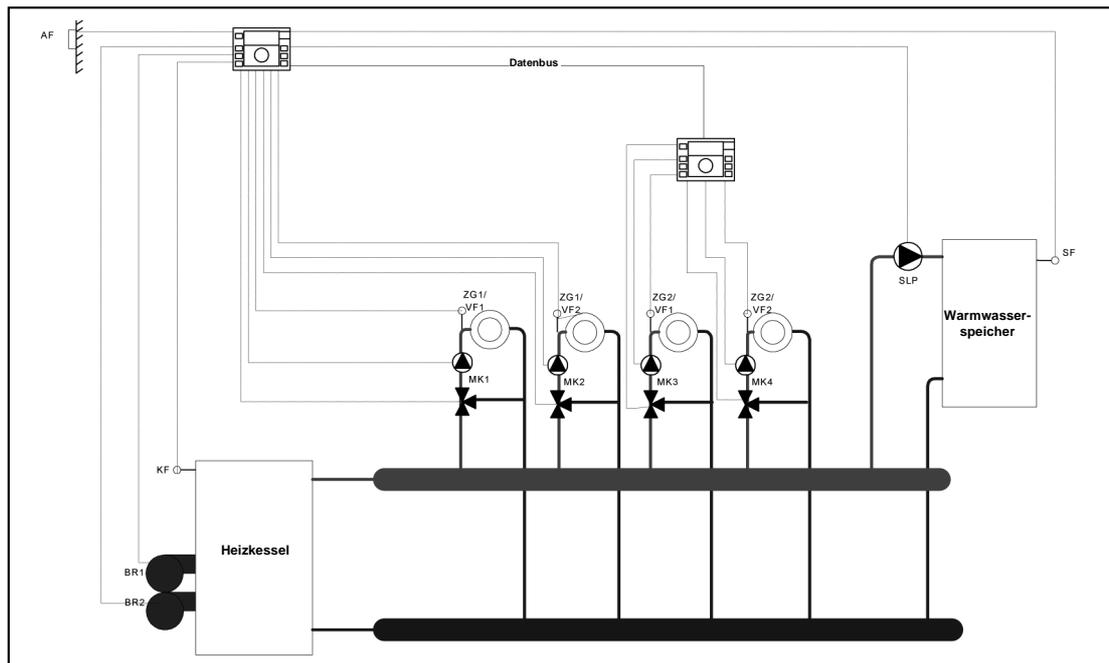
An das erste Regelgerät mit der Busadresse 10 werden folgende Komponenten angeschlossen:
