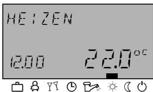
Die Betriebsart *HEIZEN* gewährleistet ständigen Heizbetrieb ohne zeitliche Einschränkungen nach der vorgegebenen Tagesraumtemperatur. Die Warmwasserbereitung arbeitet ständig nach vorgegebener Wassererwärmer-Tagestemperatur.
