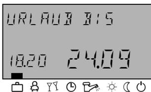
Im Urlaubsbetrieb können die Heizkreise für die Dauer des Urlaubs je nach Voreinstellung (Heizkreis-Parameter 25) frostgesichert ausgeschaltet oder entsprechend der Einstellungen für Betriebsart REDUZIERT betrieben werden. Warmwasser ist frostgesichert abgeschaltet.
