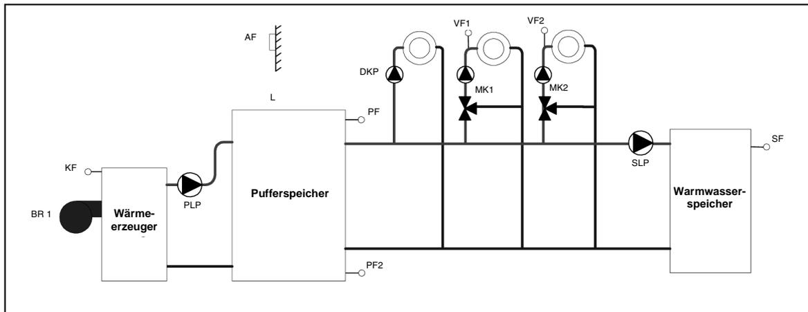
Heizkreis- und Warmwasserregelung geben ihren Anforderungswert an die Pufferregelung. Die Pufferregelung fordert bei Bedarf zusätzliche Energie vom Wärmeerzeuger über die Pufferladepumpe an.
