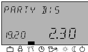
Der Partybetrieb bewirkt ein einmaliges Zwischenheizen aller Heizkreise bis zu einem vorgegebenen Zeitpunkt und überbrückt einen bevorstehenden oder bereits aktiven Absenkyklus ganz oder teilweise. Nach Ablauf der eingestellten Zeit kehren die Heizkreise selbstständig in die Betriebsart zurück, die vor dem Partyprogramm aktiv war. Kurzzeitprogramme wie *ABWESEND* oder *URLAUB* werden dabei übersprungen.
