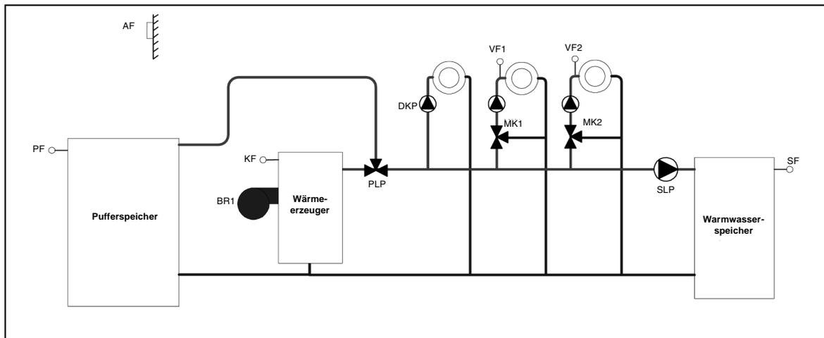
Heizkreis- und Warmwasserregelung geben ihren Anforderungswert an die Pufferregelung. Der Ausgang PLP schaltet EIN, wenn der Energiebedarf durch den Puffer gedeckt werden kann. Reicht die Energie im Puffer nicht aus, fordert die Pufferregelung bei Bedarf zusätzliche Energie vom Wärmeerzeuger an, die PLP schaltet AUS.
