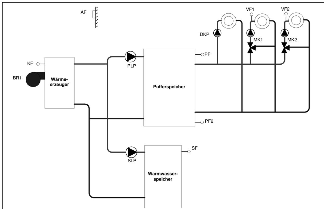
Die Heizkreisregelungen geben ihren Anforderungswert an die Pufferregelung. Die Warmwasser- und die Pufferregelung fordern bei Bedarf Energie vom Wärmeerzeuger an.
