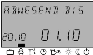
Mit der Betriebsart *ABWESEND* wird der Heizbetrieb bei kurzfristiger Abwesenheit vorübergehend frostgesichert abgeschaltet. Während der Abwesenheit werden alle Heizkreise nach der vorgegebenen abgesenkten Raumtemperatur geregelt. Nach Ablauf der eingestellten Zeit kehren die Heizkreise selbständig in die Betriebsart zurück, die vor dem Wechsel in den Abwesenheitsbetrieb aktiv war. Kurzzeitprogramme wie *PARTY* oder *URLAUB* werden dabei übersprungen.
