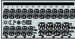
Bei Inbetriebnahme bzw. bei jeder Spannungs-Wiederkehr nach Netzausfall erscheinen vorübergehend alle im Display verfügbaren Segmente
