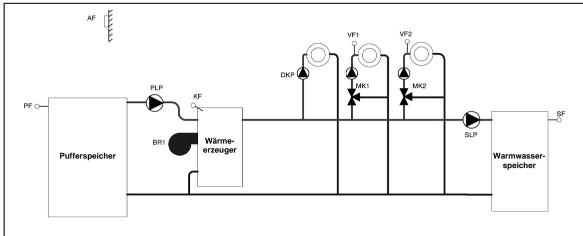
Diese Hydraulik kommt zur Anwendung, wenn bei bestehenden Anlagen ein mit alternativen Energien gespeister Pufferspeicher ergänzt wird. Oft sind hier bereits Unit-Kessel im Einsatz, bei denen der Warmwasserspeicher und die WW-Ladung im Kessel integriert sind.
