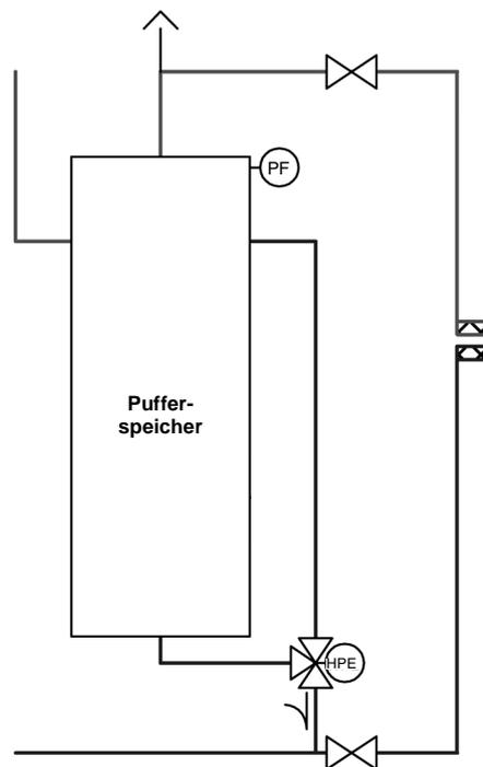
Bei Pufferladesystemen (Pufferbetriebsart 1,2 und 5) wird ohne Pufferentlastung zunächst der Pufferspeicher vom WEZ geladen bevor die Heizkreise Energie entnehmen können. Durch die hydraulische Pufferentlastung wird zunächst der obere Pufferbereich geladen und die Heizkreise zugeschaltet. Anschließend erfolgt eine Umschaltung des HPE-Ventils, damit der gesamte Puffer durchladen wird.
