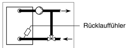
Gesteuerte Vorlaufbeimischung mittels Mischer oder Mischventil
