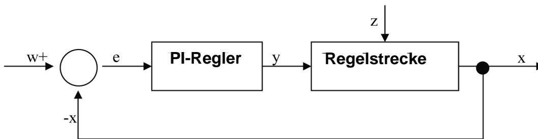
**PI-Regler:** Ist der Teil des Regelkreises, der unter Berücksichtigung der dynamischen Eigenschaften der Regelstrecke aus der Regelabweichung die Korrekturmaßnahmen zum Ausregeln ergreift.
