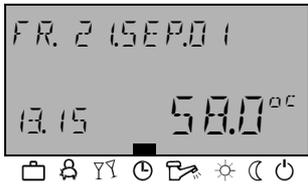
Im Automatikbetrieb stehen maximal 3 Zeitprogramme mit unterschiedlichen Heizbetriebszeiten zur Verfügung. Diese werden bei Inbetriebnahme als werkseitig festgelegte und unverlierbare Standardprogramme P1, P2 oder P3 aufgerufen und können bei Bedarf in der Schaltzeitebene (siehe Menü "Schaltzeiten") mit eigenen Schaltzeiten überschrieben werden.
