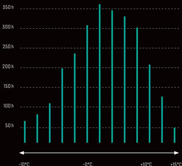
Celui-ci est réglementé par la norme EN14825 et est déterminé par une procédure d'essai complexe dans un institut de contrôle certifié. Pour ce faire, la performance de la pompe à chaleur est testée à différentes plages de température. Aussi bien la limite d'utilisation (à -20°C) que les points de contrôle à -10°C, -7°C, 2°C, 7°C et 12°C, sont mesurés avec précision.
